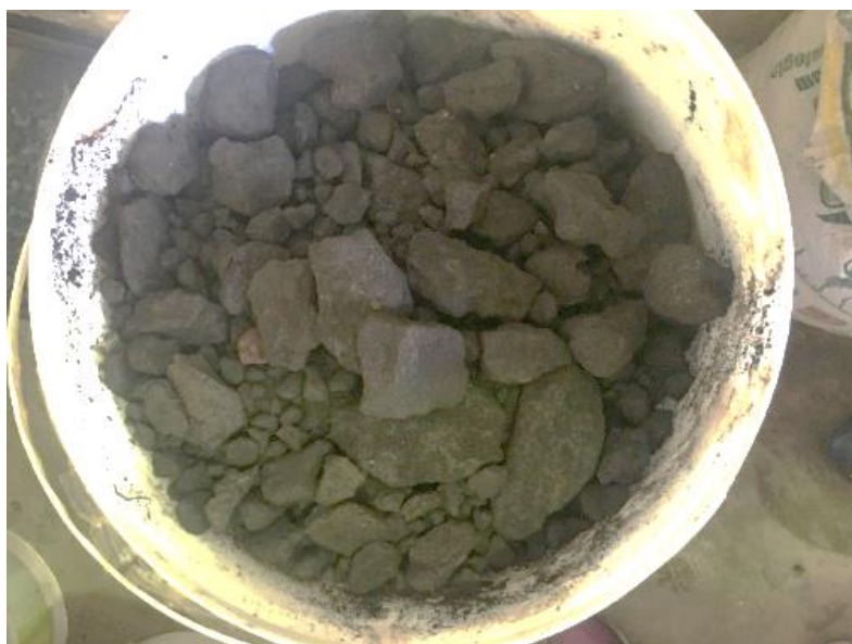
Figura 3.6 – Variação de tamanho do resíduo de manganês a ser utilizado como agregado graúdo.
